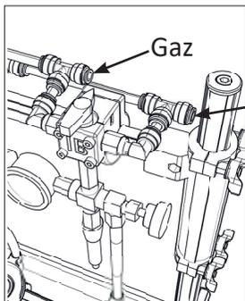
F. Connectez les tuyaux gaz et liquide en suivant les indications fléchées
